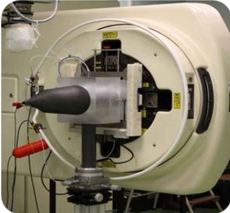
Figure 1 : Collimateur/ atténuateur installé sur le LINAC du LIST LNHB
